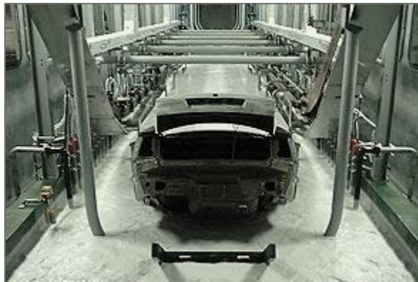
Figura N°1. Carrocería ingresando a tanques del sistema ELPO
