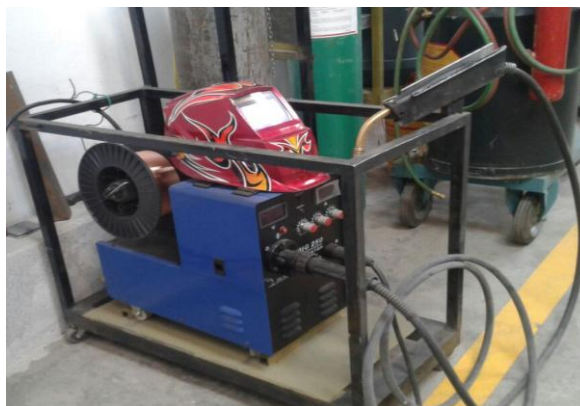
Figura N° 13: Máquina de soldar
