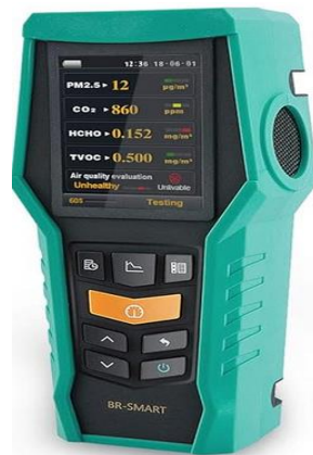
Imagen 2. Monitor portátil de calidad del aire.
