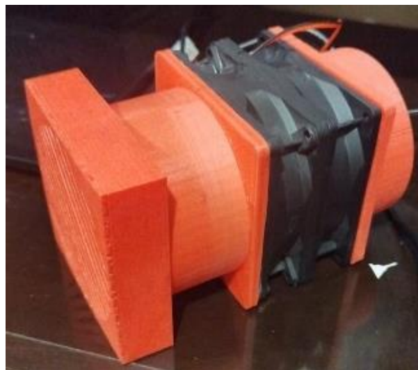
Imagen 8. Purificador terminado con filtro de carbón activado. Elaborado por: Lara-Calle (2023)
