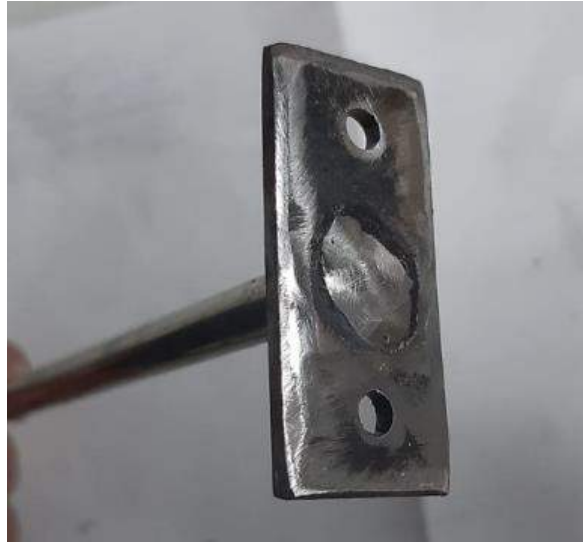
Imagen 13. Soldadura de eje con placa de acero
