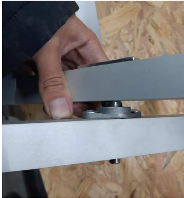
Imagen 15. unión de tubos de aluminio – parte inferior de los marcos
