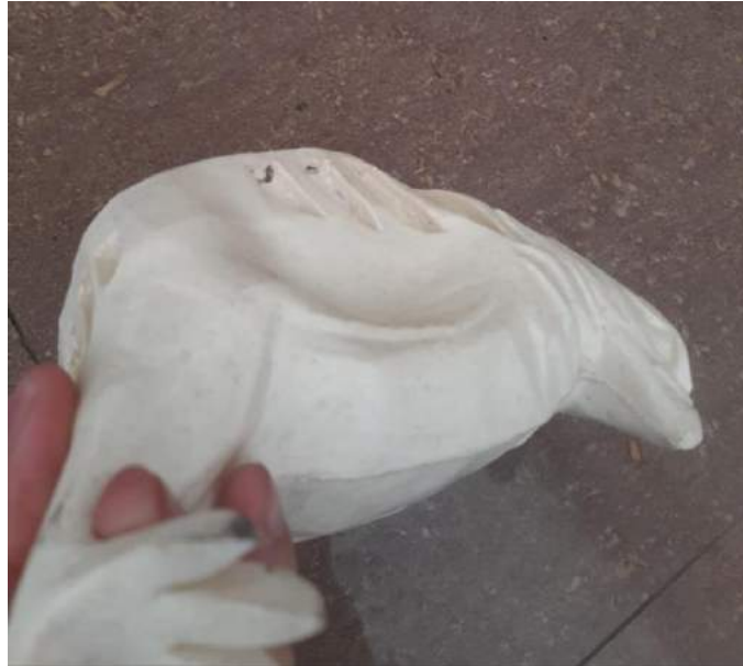
Imagen 5. Pieza defectuosa con hundimiento en el costado
