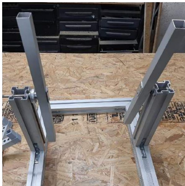
Imagen 14: lado izquierdo del eje X con chumacera
