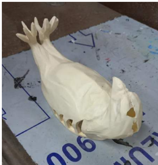
Imagen 4. Pieza defectuosa con ruptura en la cabeza
