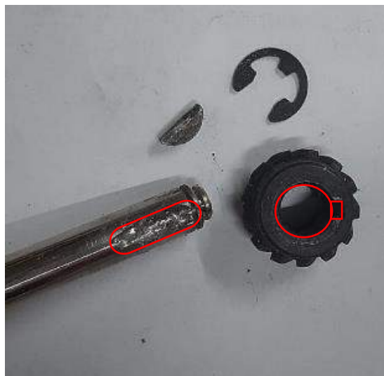
Imagen 17. Eje con hendidura para adaptarse a la ranura del piñón conductor
