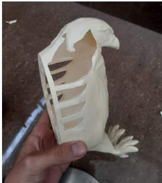
Imagen 6. Pieza defectuosa que presenta fragilidad en la parte superior
