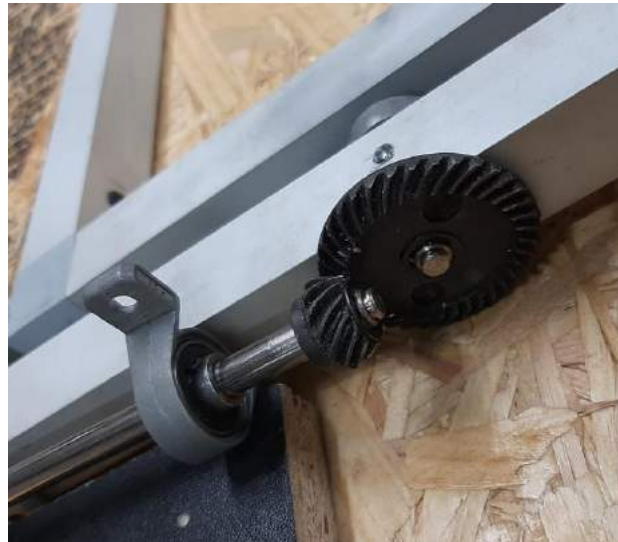
Imagen 18. Piñones unidos en el eje Y superior
