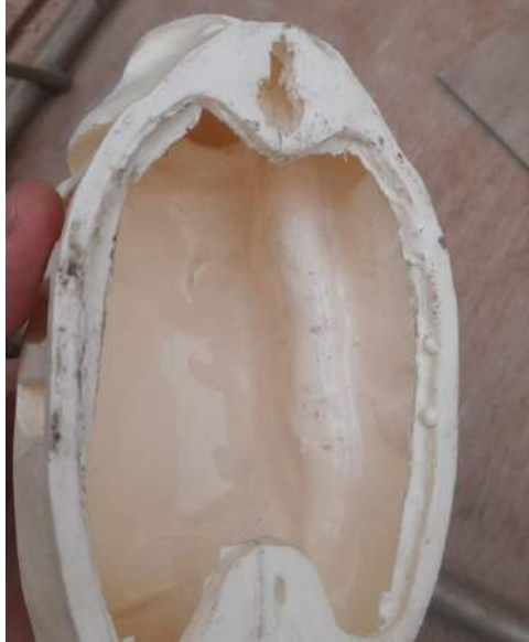
Imagen 7. Pieza defectuosa con acumulación de resina en un lado
