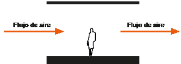
Figura O4. Ventilación Cruzada
