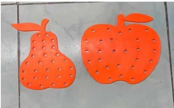
El proceso concluye con una inspección visual para prevenir defectos, como rebabas. En caso de detectarse, se procede a su retirada, garantizando así la integridad y acabado impecable del producto final.
