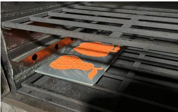
Retiramos del horno y esperamos que se enfríe antes de pasar al proceso de desmoldado, ya que quitarlo prematuramente podría resultar en la posible rotura del producto debido a la falta de rigidez necesaria.”
