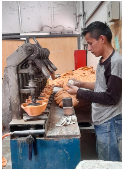
Imagen 2. Pegadora manual de válvulas al blader.
