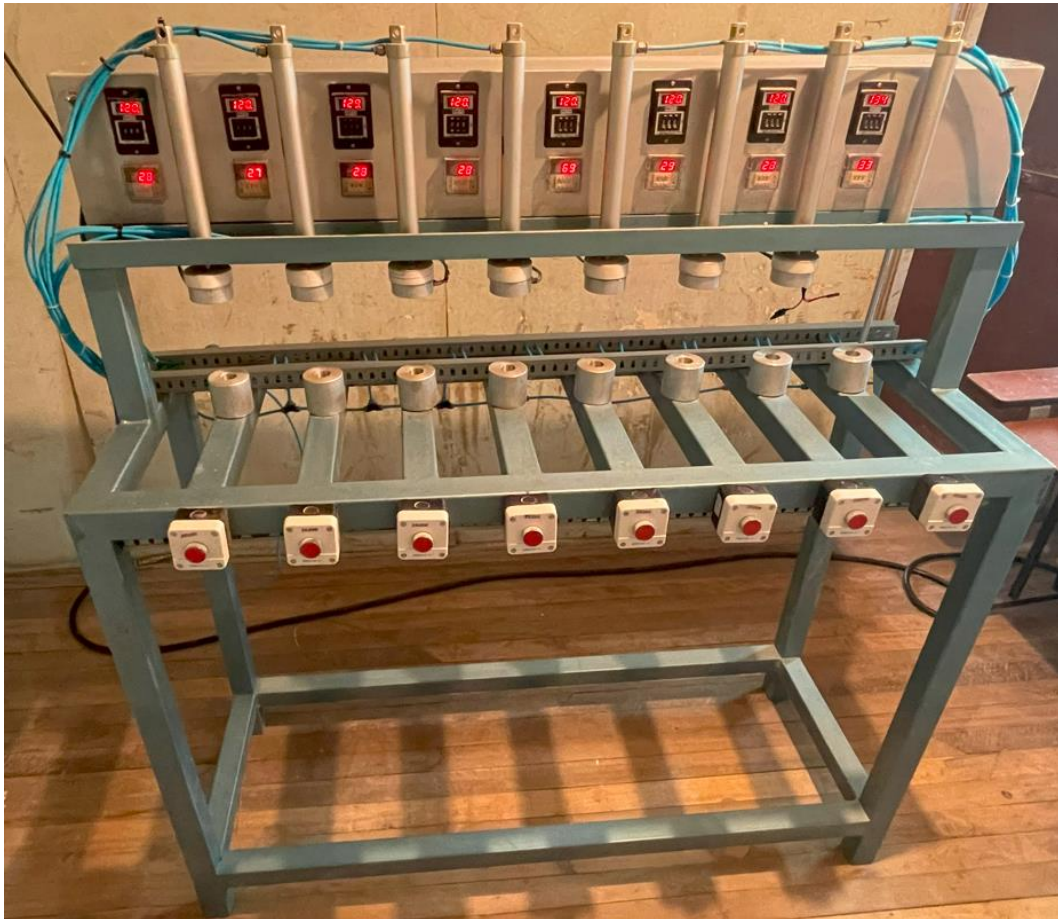
Imagen 14. Máquina automatizada pegadora de válvulas. Elaborado por: Parra, Sebastián (2023).
