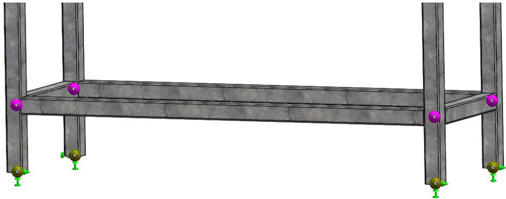
Imagen 9. Puntos de fijación en el modelado de la estructura en SolidWorks. Elaborado por: Parra, Sebastián (2023).
