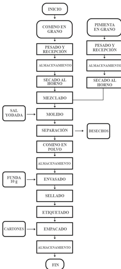
Gráfico No. 2 Diagrama de flujo de proceso de elaboración de comino molido.
