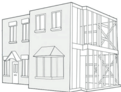
Fig. 7: Sistema Constructivo steel frame
