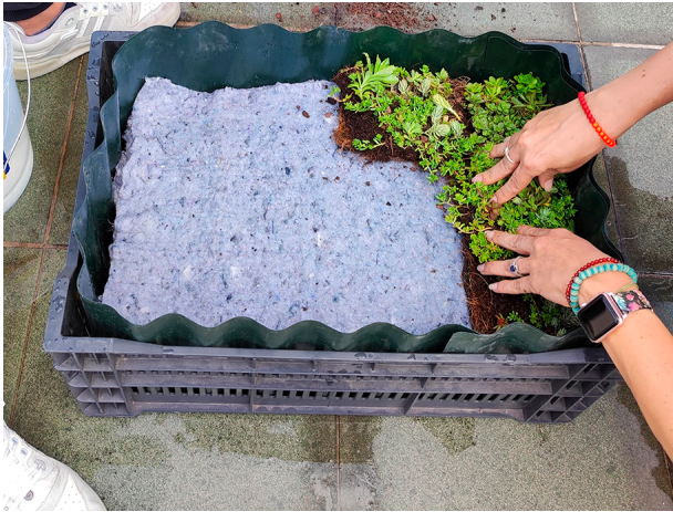
Figura 93. Colocación de la capa vegetal. Fuente: Elaboración propia, 2023.
