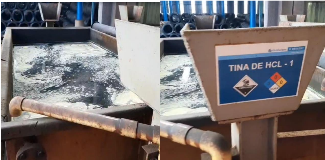
Proceso de decapado químico – tina de HCL
