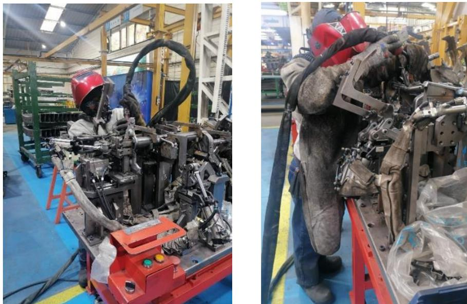
*Nota.* Fotos donde se evidencia las posiciones y manipulación de la antorcha de soldadura para soldar las barras de tablero.
