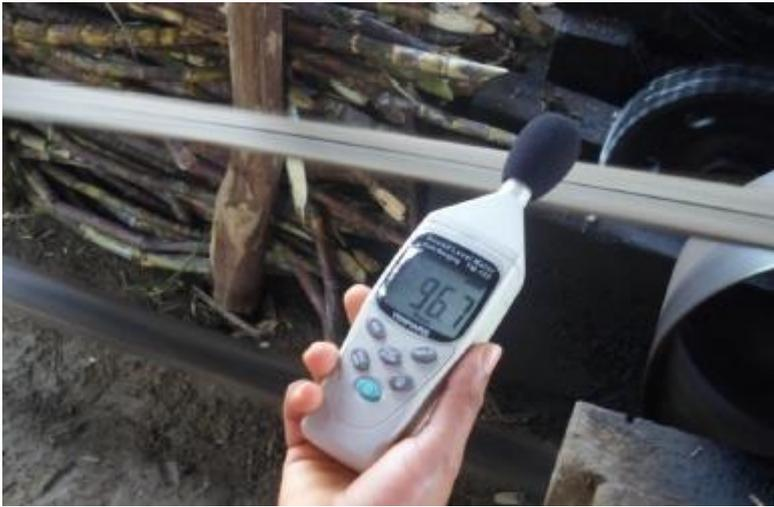
**Nota:** El equipo utilizado para la respectiva medición es un sonómetro marca TENMARS TM-102 Sound Level Meter. Elaboración del autor, 2023.
