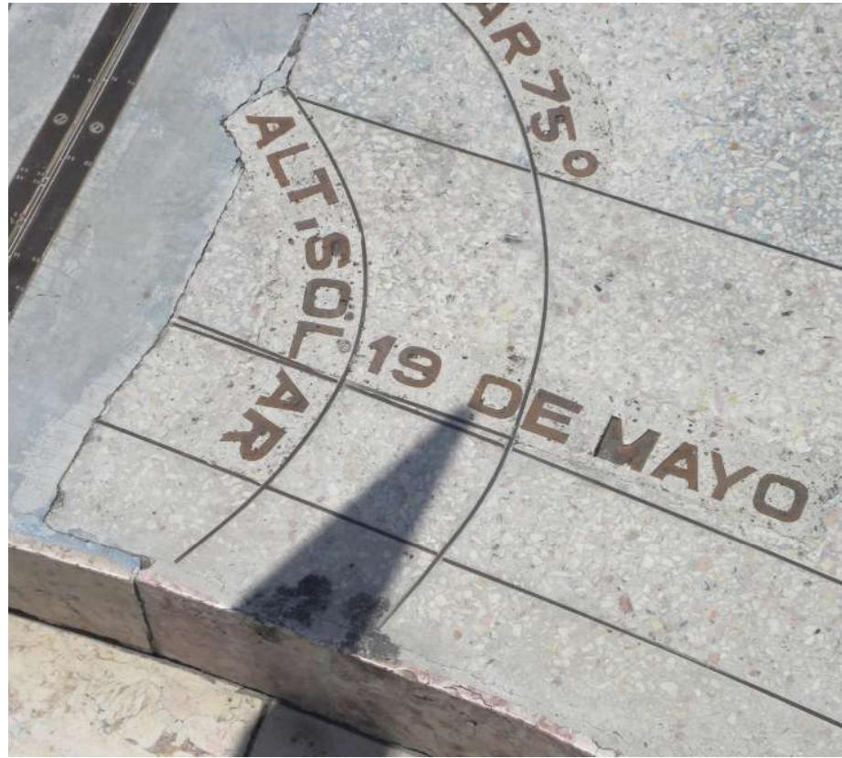
Figura 99. La sombra del extremo del gnomon marca en las líneas hiperbólicas del calendario las principales efemérides. La raya más al sur indica el momento del solsticio de verano. La única línea recta nos indica la ocurrencia de los equinoccios y la que está más al norte anuncia el inicio del invierno. Otras marcas nos hablan de Martí y su obra. Los días 21 de cada mes son significativos porque esas jornadas se parean de forma homóloga, por ejemplo, enero y noviembre, febrero y octubre, marzo con septiembre y abril con agosto; esto quiere decir que son días con similar trayectoria solar. Las coincidencias han hecho que el día 19 de mayo, muerte de Martí se homologue con el 26 de Julio, de manera que ese día la sombra del gnomon se mueve exactamente por la marca correspondiente a la fecha de la caída del Apóstol y sea iluminada la escultura por el reflector solar a las 2:39 PM. Un grupo de círculos concéntricos dispuestos también en el pavimento, definen los lugares geométricos correspondientes a determinados intervalos de altura solar. En los casos del calendario y el reloj solar, el piso es de terrazo integral.
