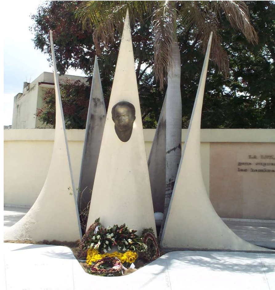
Figura 102. Fotografía tomada el 19 de mayo del año 2000 a las 2:27 de la tarde. Obsérvese cómo la luz que refleja el Espejo está irrumpiendo en el rostro de la escultura. El reflector ubicado a diez metros de la efigie y a una altura de tres metros tiene un ángulo de inclinación vertical que responde al parámetro altura solar. La alineación del punto centro del reflector y el centro de los arcos superciliares de la escultura está definida por el ángulo acimutal del Sol para esa hora y fecha. Este efecto, esperado todos los años por un nutrido grupo de amantes de las tradiciones y la ciencia astral, puede observarse durante 15 minutos desde que comienza hasta su fin. Primero, el haz de luz alumbró el pavimento del calendario hasta que llega al soporte y lo remonta hasta que hace contacto con la pieza de bronce iluminándola de forma plena.
