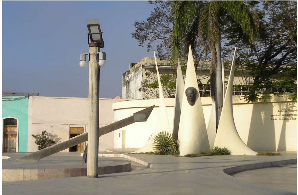
Figura 96. Foto en la que pueden ser observados los tres componentes astronómicos más significativos de la Plaza Martiana de Las Tunas: el reloj solar, el calendario y el reflector solar conmemorativo. Vea como la sombra del gnomon marca simultáneamente la hora y la fecha sobre la escala del reloj y en las líneas del calendario solar. El reflector sobre el pedestal de hormigón es un espejo plano corriente sin aberración. Puede verse además la forma hiperbólica del pavimento que conforma el calendario; esta silueta se debe a la trayectoria de las sombras dentro de la franja tropical de La Tierra.
