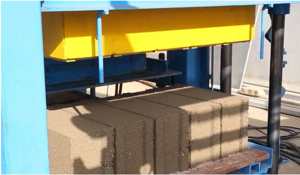
Fuente:(Fotografía18; Maquinaria Gm4-25) Fase 10 desmonte y ubicación para su secado
