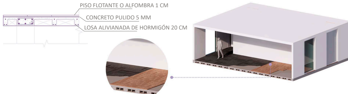
Figura 66: Aislamiento Losa de Entrepiso Caso Base. Fuente: Elaboración Propia. 2023.
