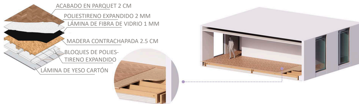
Figura 67: Aislamiento Losa de Entrepiso Caso Mejorado. Fuente: Elaboración Propia. 2023.
