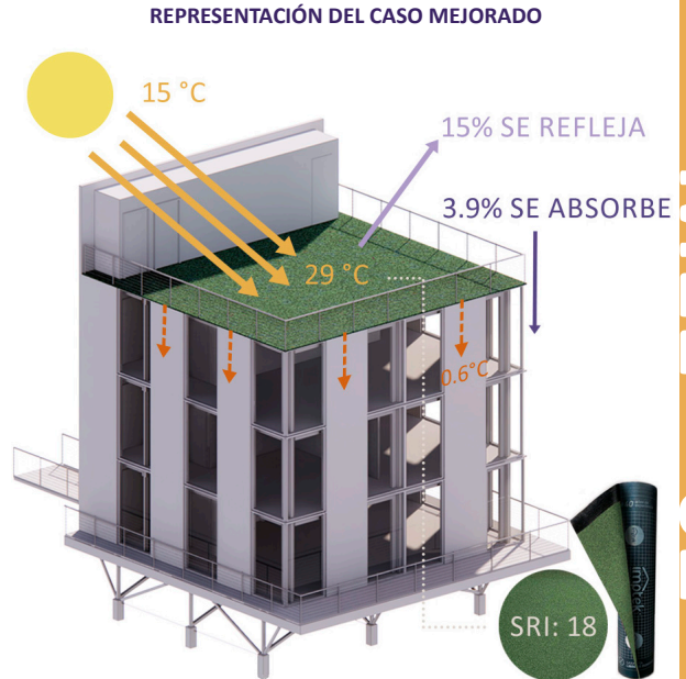
Figura 56: SRI Techo Caso Mejorado y Absorción de Calor Fuente: Elaboración Propia. 2023.
