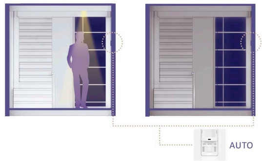
Figura 85: Iluminación con Sensor de Encendido Apagado. Fuente: Elaboración Propia. 2023.
