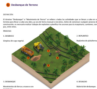
Figura 27 Ejemplo proceso constructivo Fuente: Elaboración propia, (2023)
