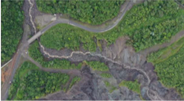
Ilustración 5 Ilustración 3 Ilustración 1 Erosión de río Coca y de su tributario Piedra Fina nuevamente amenazan oleoductos y vía nacional. Foto: OCP Ecuador.
