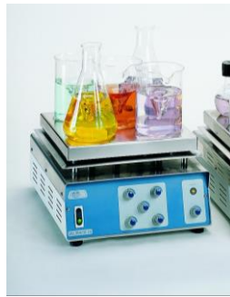
Agitador "Multimatic" 5-- Temperatura máxima de 300°C N con calefacción
