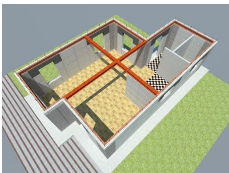
15.- vigas principales de entre piso.
