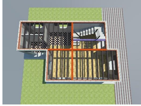
18.- colocación de gradas.
