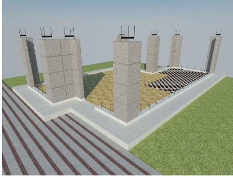
9.- muros portantes esquineros planta baja.
