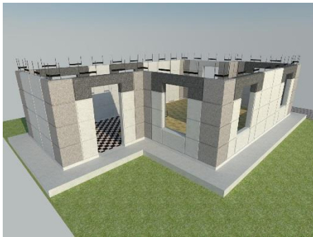
11.- dintel de ventana y puerta planta baja.
