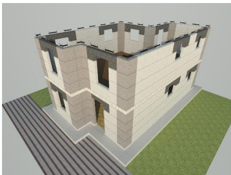
23.- dintel de ventana planta alta
