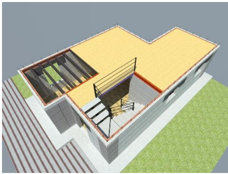
19.- colocación de piso tablero OSB.
