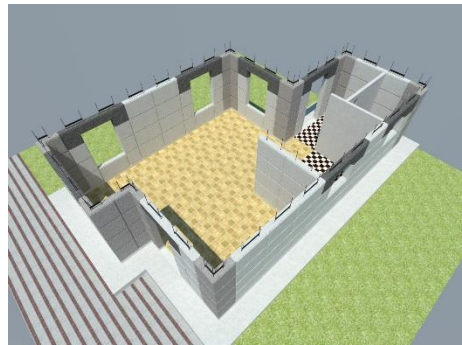
12.- paredes interiores planta baja.
