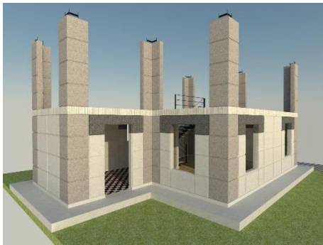
21.- muros portantes esquineros planta alta
