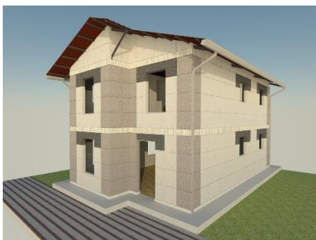
31.- canales y bajantes de agua PVC.
