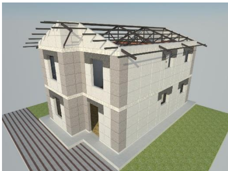
29.- remate de cubierta con bloque de H.C.
