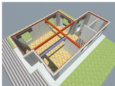
16.- vigas secundarias de entre piso.
