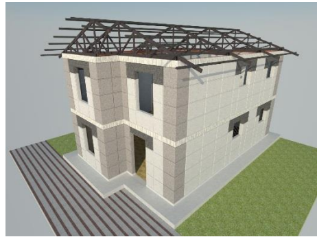
28.- correas de cubierta
