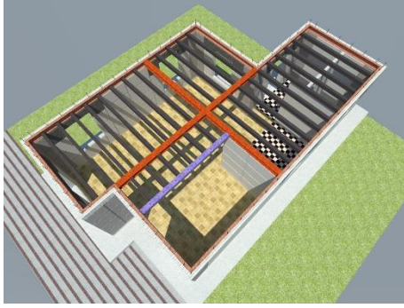
17.- viguetas de entre piso.
