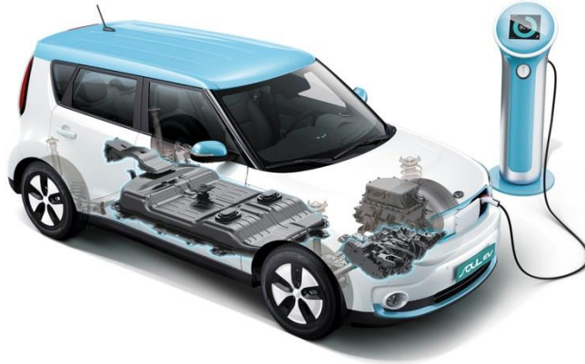
Figura 3.-Vehículo eléctrico y sus componentes principales.
