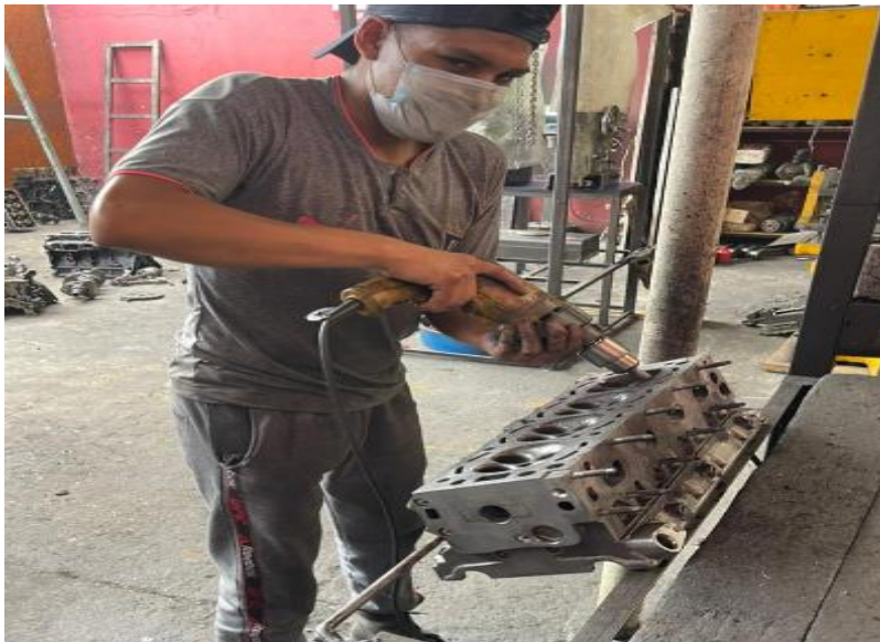
Imagen 6. Inspección de cabezotes Fuente. Empresa Rectimotor
