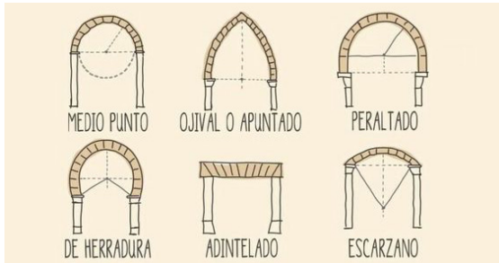
Figura 8 Curvaturas de arcos con uno o más centros en su formación.
