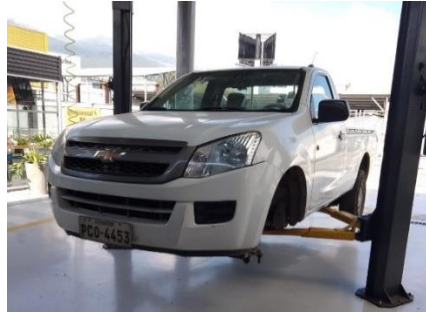
Figura 10. Elevador para realizar el proceso de cambio de frenos
