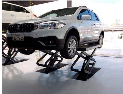
Figura 12. Elevador para realizar cambio de aceite
