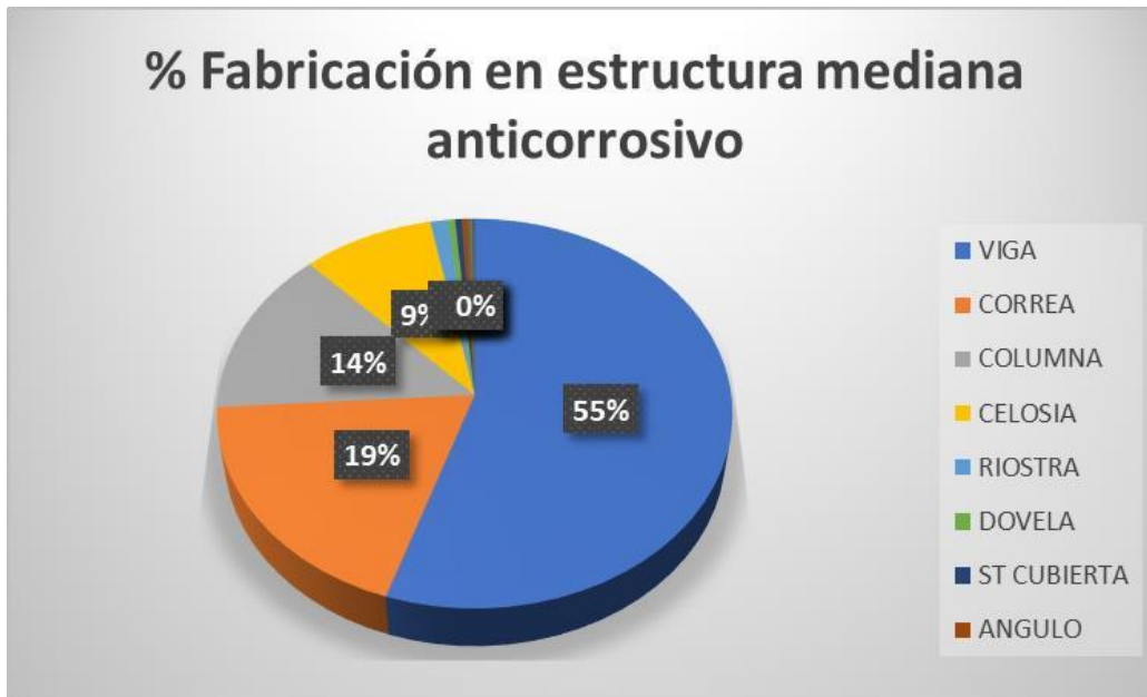
Gráfico No. 10: Porcentaje fabricación en estructura mediana anticorrosivo
