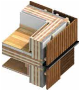
Figura 4: Detalle constructivo del CLT
