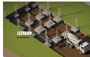
Imagen 29. Llenado de Zapata Fuente: (Pierola,2022)
