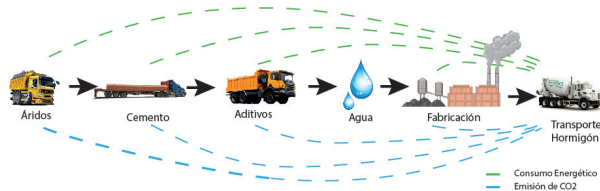
Diagrama 2. Proceso de fabricación del Hormigón Fuente: Elaboración Propia (2022)
