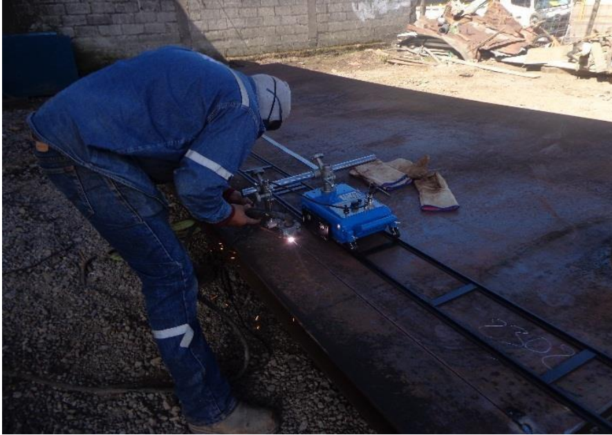
Imagen 29: Corte con plasma Elaborado por: Moreno, Wilson (2022)
