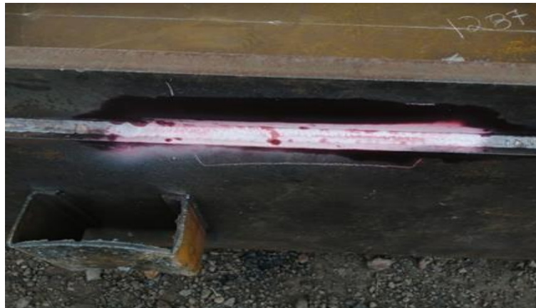
Imagen 108: Inspección de patines Elaborado por: Moreno, Wilson (2022)
