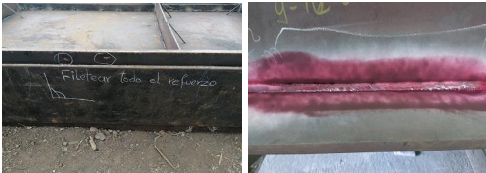
Imagen 98: Inspección de patín inferior Elaborado por: Moreno, Wilson (2022)
