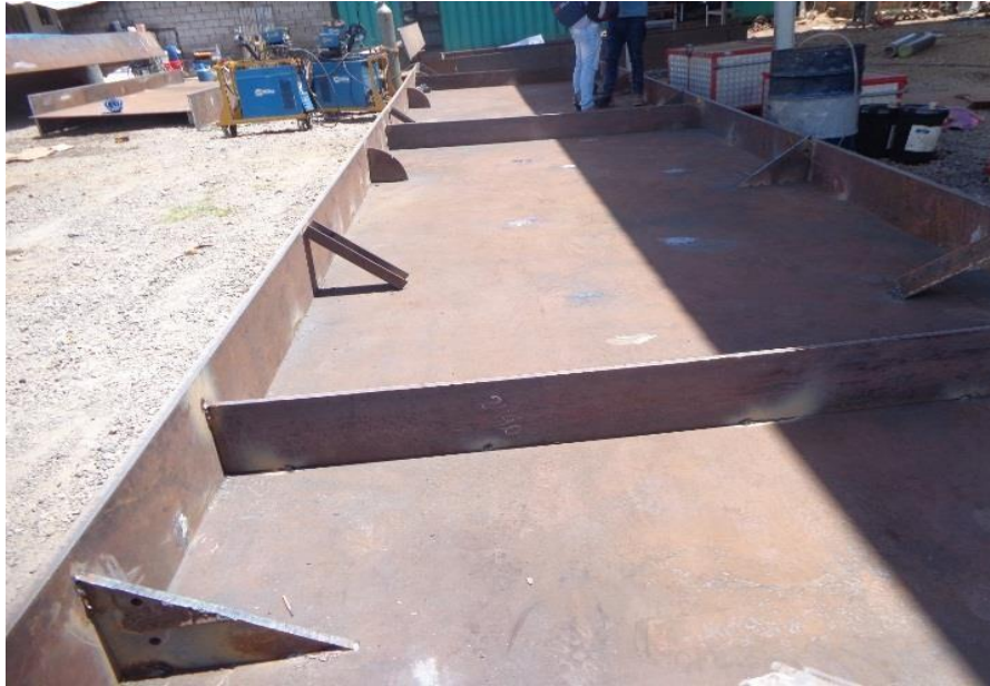
Imagen 41: Colocación de escuadras temporales para evitar deformación de alma patín Elaborado por: Moreno, Wilson (2022)
