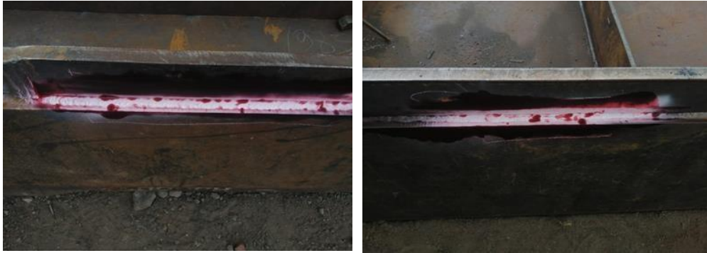
Imagen 97: Inspección de patín superior Elaborado por: Moreno, Wilson (2022)
