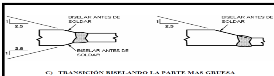
Imagen 54: Transición de uniones a tope en partes de espesor desigual Fuente: (COLOMA VERA, 2011)
