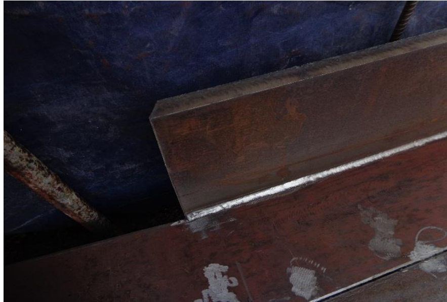
Imagen 39: Proceso de soldadura alma patín Elaborado por: Moreno, Wilson (2022)
