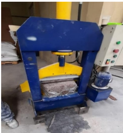
Imagen 2 Preparación del caucho
