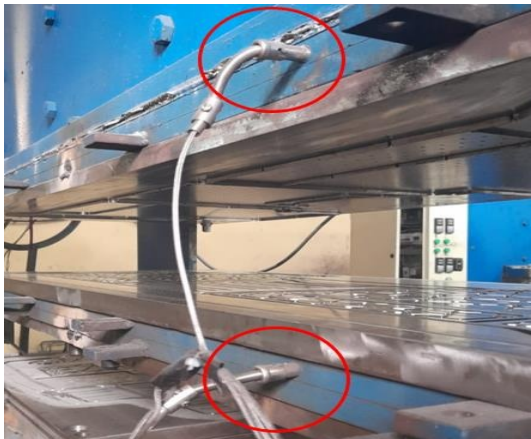
Imagen 20 Sensor de temperatura
