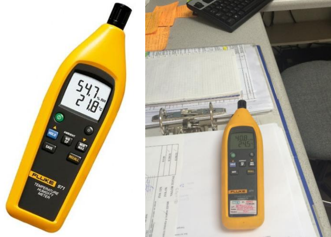
Figura No. 7 Termohigrómetro Marca FLUKE
