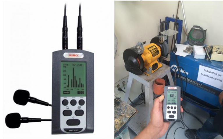
Figura No. 6 Sonómetro Marca KIMO
