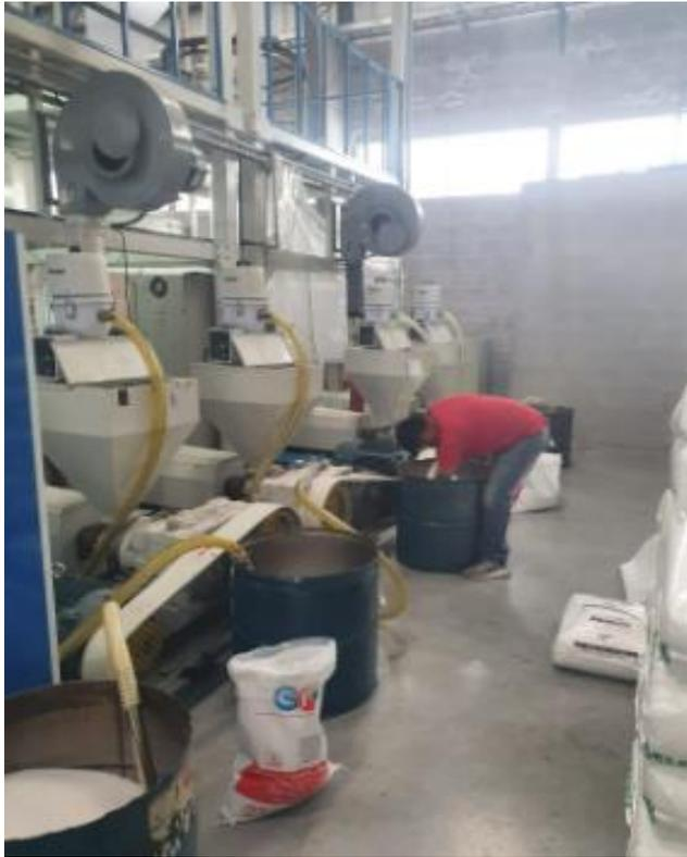
**Figura 4.** Mezclado de material en recipientes de 50 Kg
