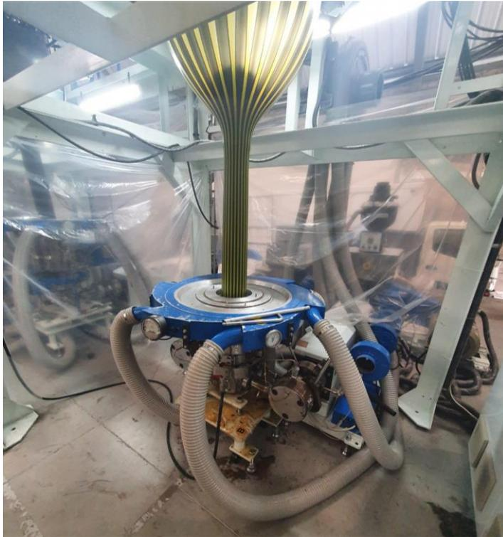
**Figura 5.** Salida del material por el cabezal en forma de burbuja
