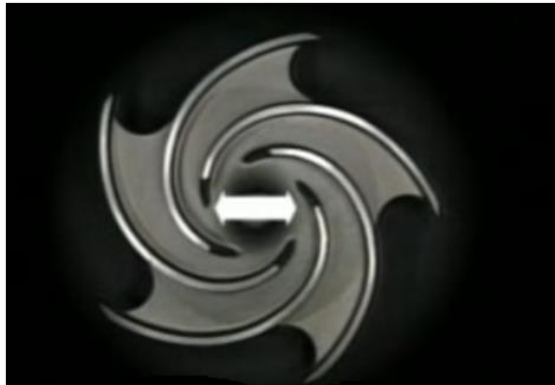
Figura 49 Modificar el área del ojo en la entrada del impulsor.
