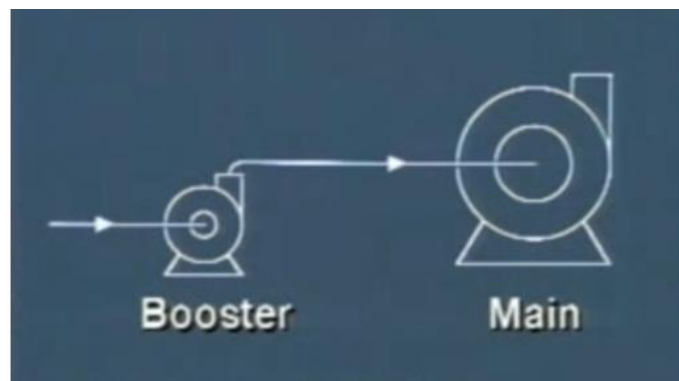
Figura 53 Instalación de bomba de refuerzo.
