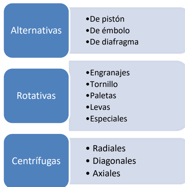
Figura 11 Tipos de bombas Fuente: Carnicer Royo (2004, pág. 19). Elaboración: César Ríos
