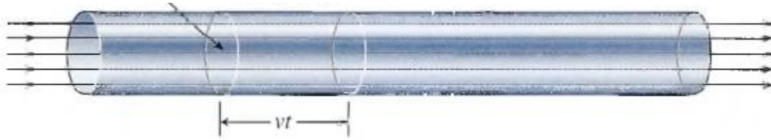
Figura 7 Cálculo de la velocidad de un fluido que circula por un tubo Fuente: Tippens (2011, pág. 316)
