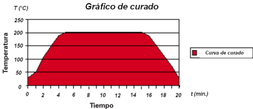
Figura 35: Curva de curado epoxi.
