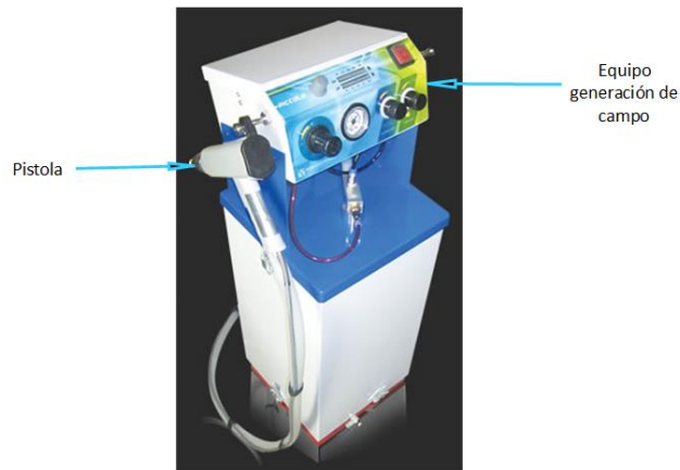
Figura 6: Equipo de pintura electrostática
