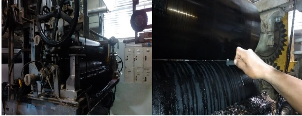
Figura 31: Calibración de rodillos en Línea de Laminación N°1
