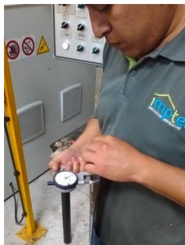
Figura 16: Medición de espesor en láminas asfálticas.
