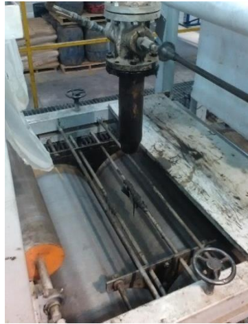
Figura 32: Calibración de rodillos en Línea de Laminación N°2
