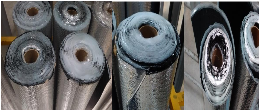
Figura 33: Lámina desbordada por mástico a temperatura elevada (peso bajo)
