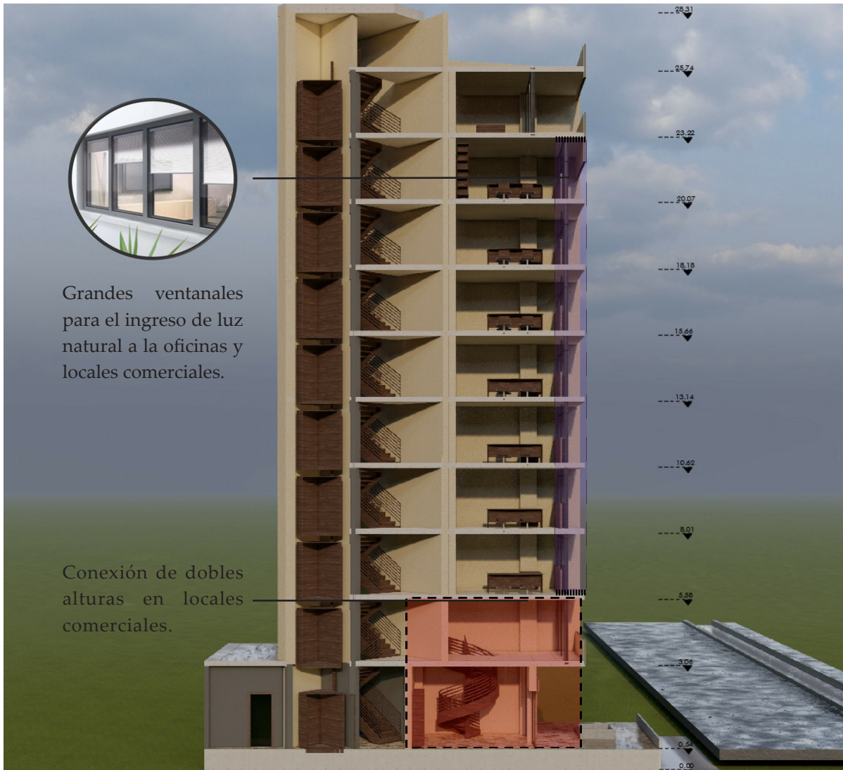
Figura 44: ESTOA edificio "El Ejecutivo". Corte transversal en perspectiva y caracterización del espacio Citrohan en la arquitectura de Oswaldo de la Torre.
