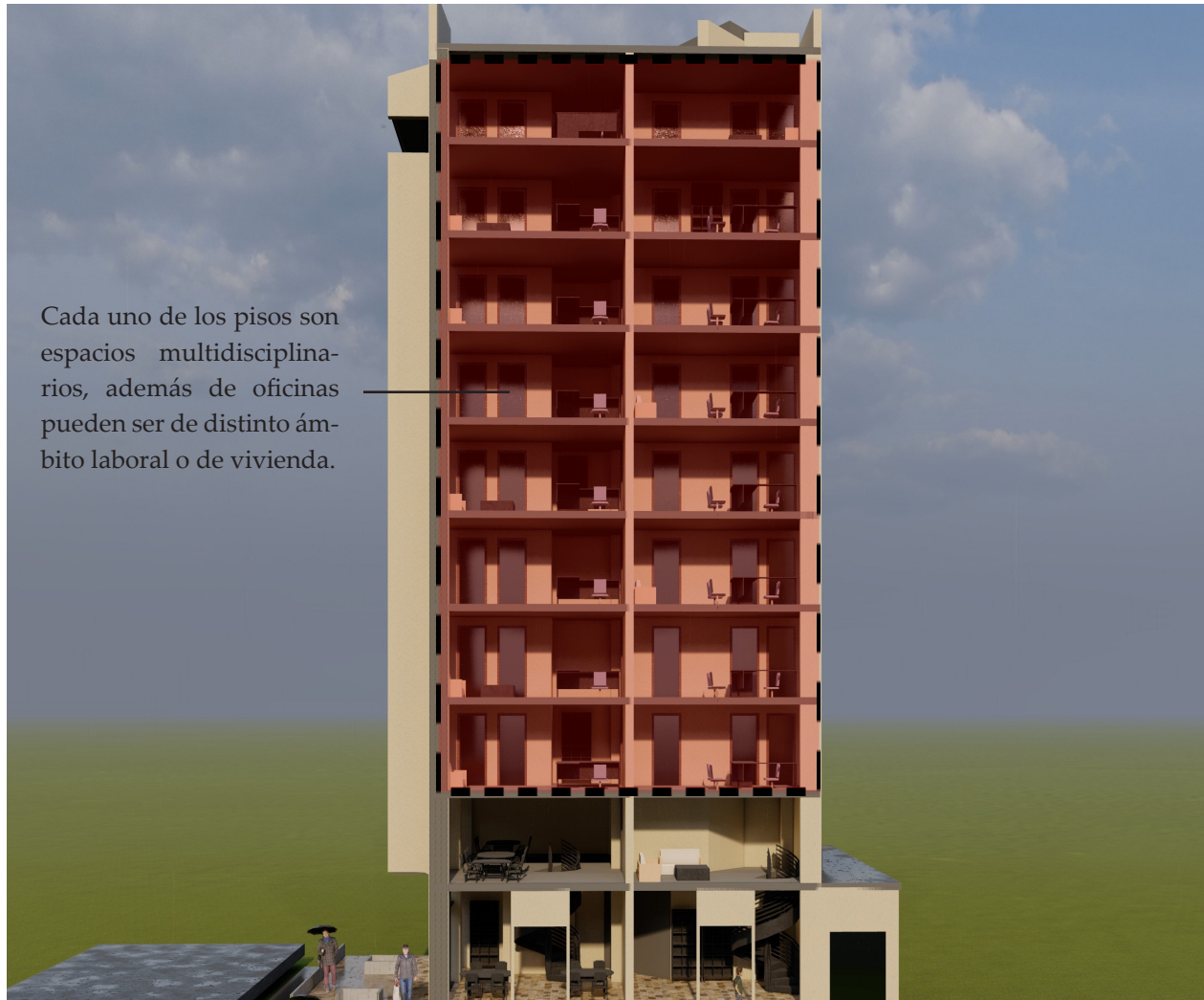
Figura 45: ESTOA edificio “El Ejecutivo”. Corte longitudinal en perspectiva y caracterización del espacio Citrohan en la arquitectura de Oswaldo de la Torre.
