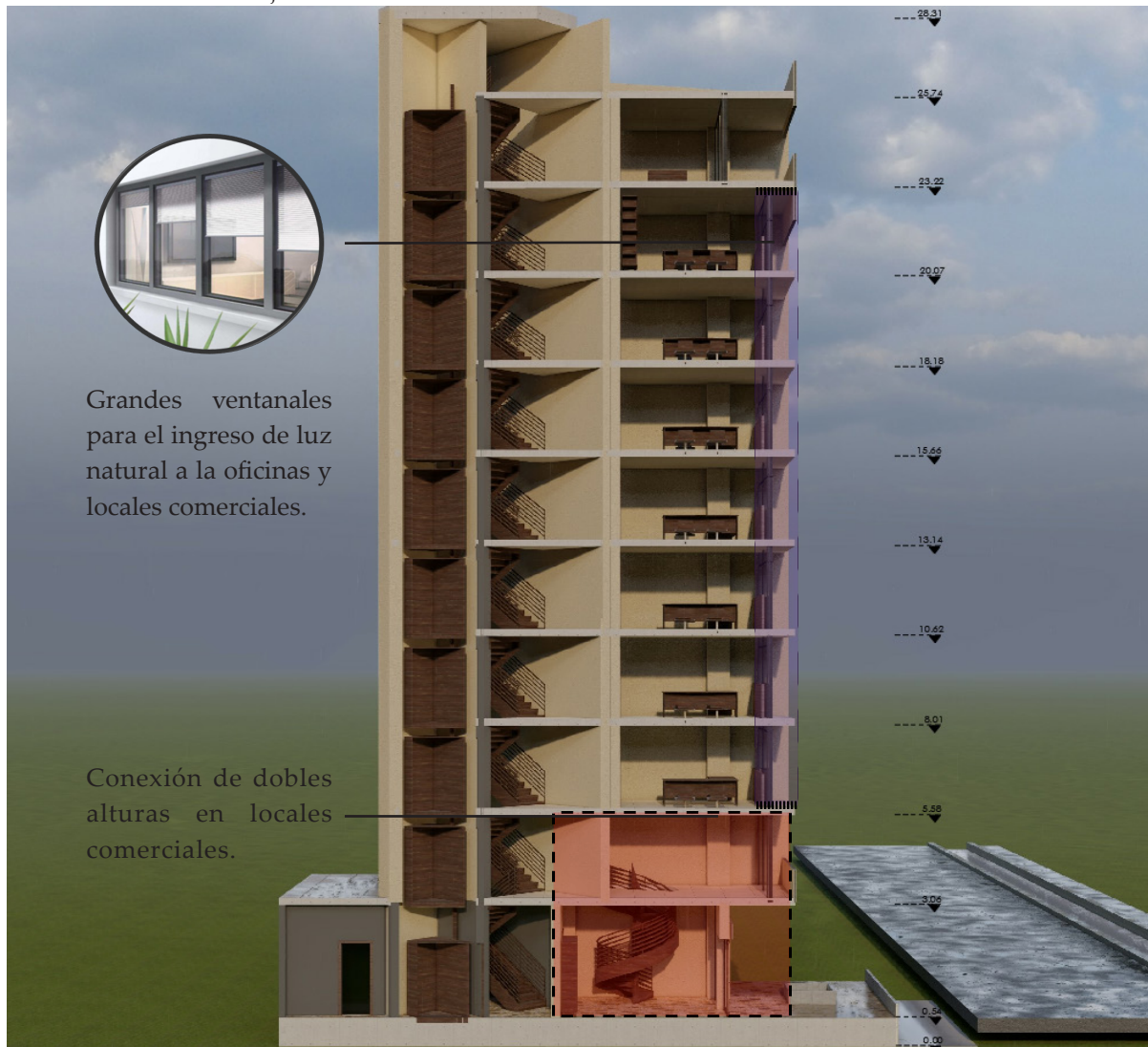
Figura 19. Corte transversal del edificio "el Ejecutivo"
