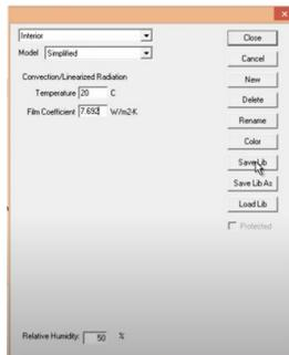
Nota: En este paso se crean condiciones de límite o de contorno de acuerdo a los requerimientos de lo que se desea analizar. Tomada del software therm.
