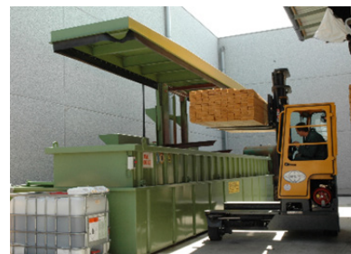
FIGURA 18 Tratamiento de la madera en inmersión prolongada.
