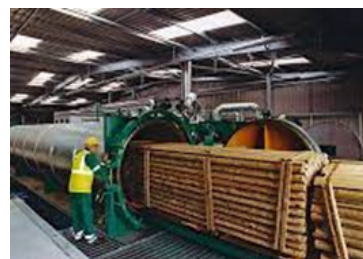
FIGURA 23 Procedimiento de célula vacía en madera
