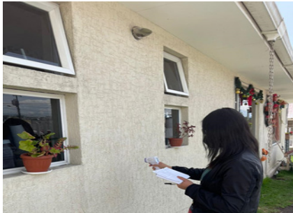
Figura 43 Recolección de datos de temperatura latente en mampostería
