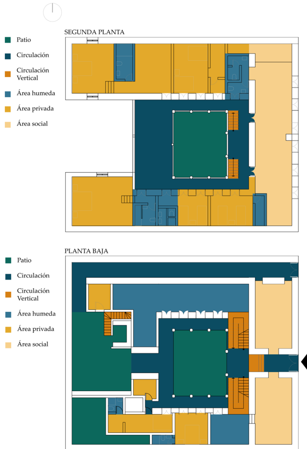
Figura 43. Diagramas en planta de zonificación de la Casa de Filia Briones, Hotel la Roka Plaza actualmente. (C2)
