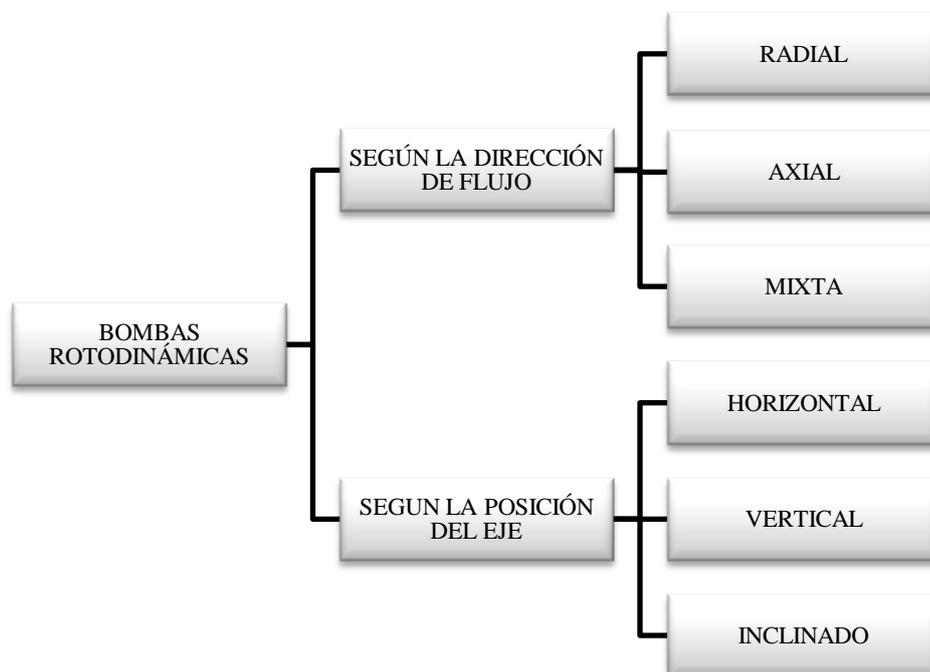
Figura N° 11: Clasificación de las bombas rotodinámicas.
