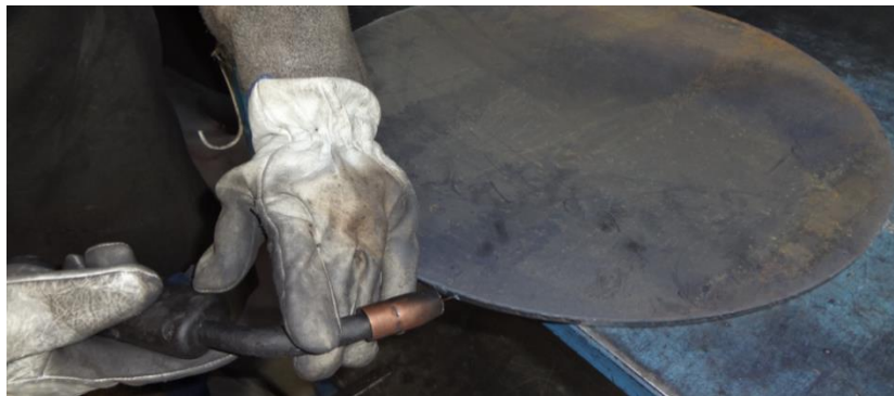
Figura N° 34: Área MIG para la recuperación de mordeduras Fuente: ATU Artículos de Acero S.A. Elaborado por: El Investigador
