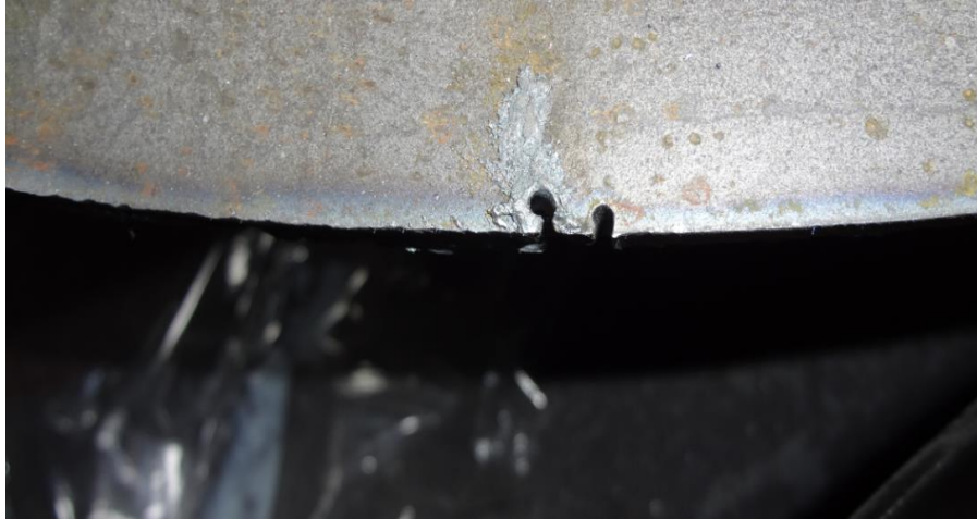
Figura N° 33: Mordeduras generadas durante el proceso de corte manual Fuente: ATU Artículos de Acero S.A. Elaborado por: El Investigador
