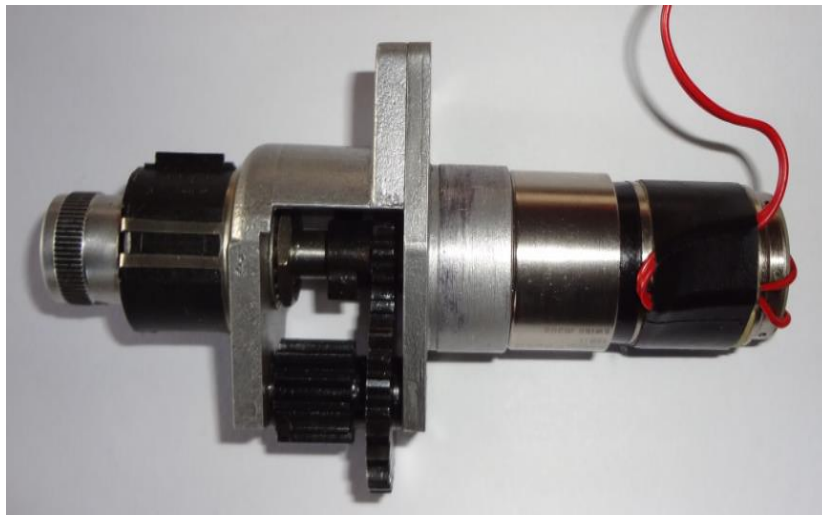
Figura N° 74: Motor Eléctrico Universal 24 Voltios DC
