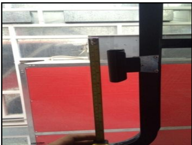
Figura N° 71: Medición de la manilla de la ventana de usuario Elaborado por: Investigador
