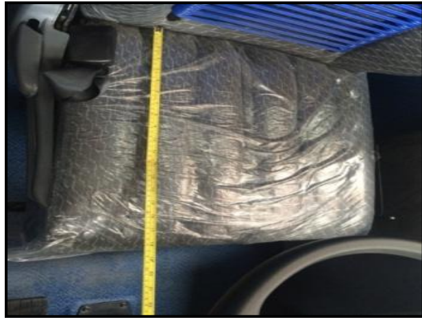
Figura N° 102: Verificación de la profundidad mínima del asiento del conductor Elaborado por: Investigador
