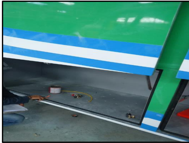
Figura N° 87: Verificación del cierre hermético del portaequipajes Elaborado por: Investigador
