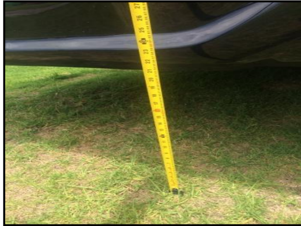
Figura N° 51: Medición de la altura máxima inferior del parachoque posterior Elaborado por: Investigador
