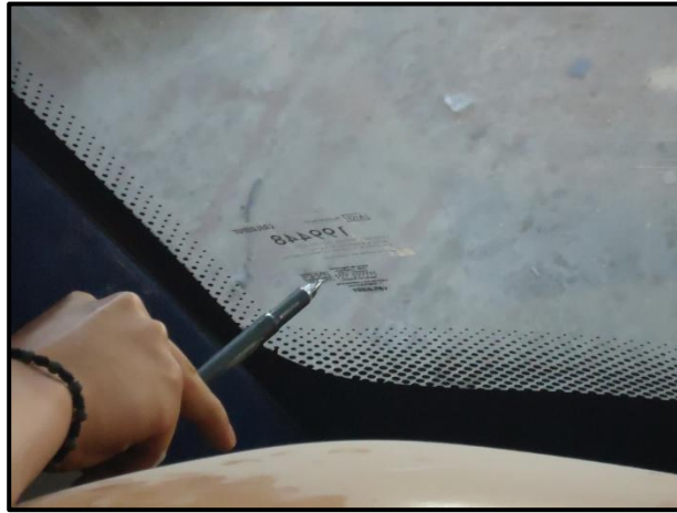
Figura N° 57: Inspección del sello del parabrisas bajo NTE INEN 1669 Elaborado por: Investigador
