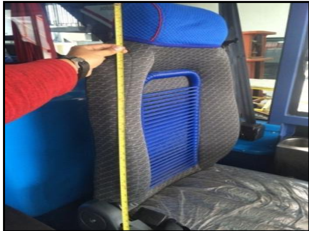
Figura N° 103: Verificación de la altura mínima del asiento del conductor Elaborado por: Investigador
