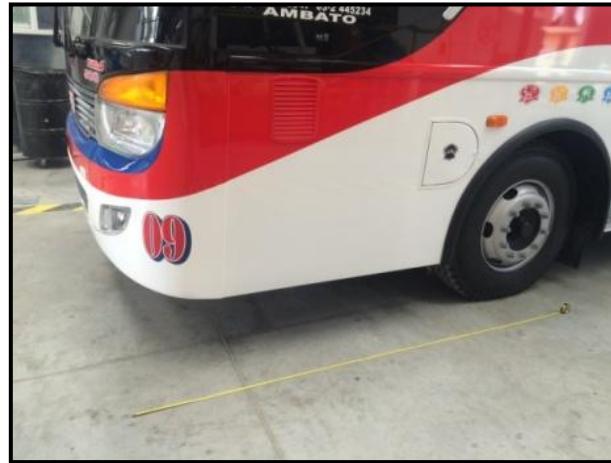
Figura N° 64: Medición del voladizo delantero del vehículo Elaborado por: Investigador
