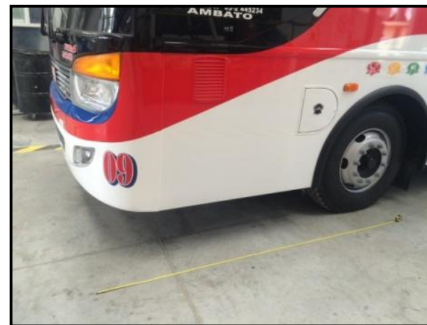
Figura N° 65: Medición del ángulo de acometida delantero Elaborado por: Investigador
