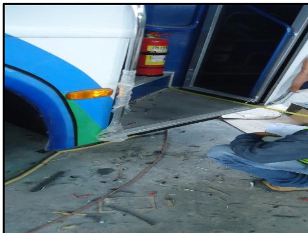
Figura N° 95: Verificación de la huella del primer peldaño Elaborado por: Investigador
