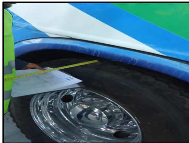
Figura N° 62: Medición del ancho del vehículo. Elaborado por: Investigador
