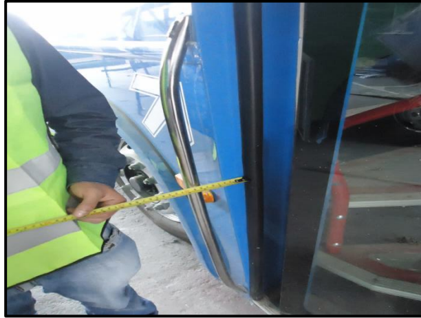
Figura N° 75: Medición que sobresale la puerta de la carrocería Elaborado por: Investigador
