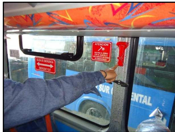
Figura N° 140: Verificación de dispositivos de desprendimiento de emergencia. Elaborado por: Investigador
