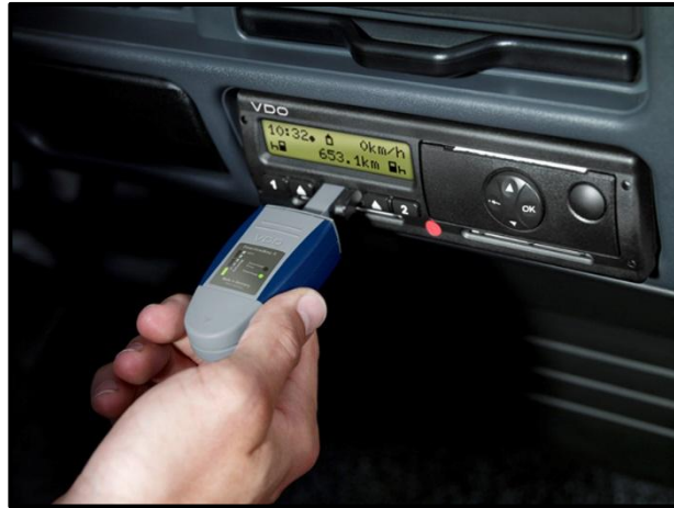
Figura N° 145: Verificación de la existencia de tacógrafo Elaborado por: Investigador
