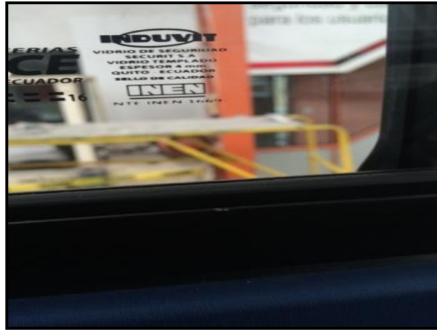
Figura N° 54: Inspección de ventanas laterales bajo NTE INEN 1669. Elaborado por: Investigador
