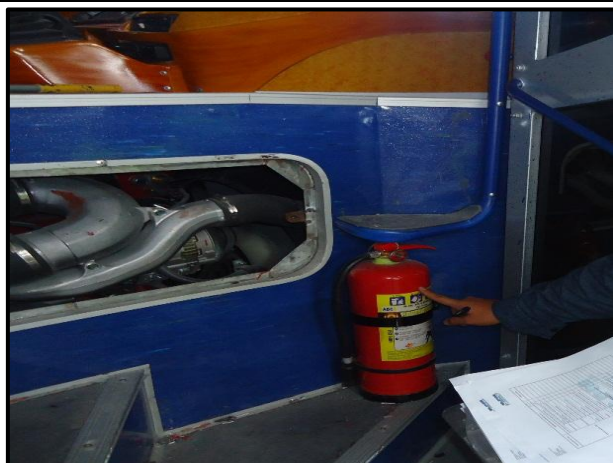
Figura N° 143: Verificación de extintor de incendios Elaborado por: Investigador
