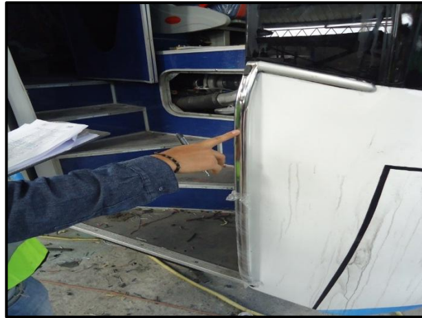
Figura N° 97: Verificación de asideros anclados a la carrocería. Elaborado por: Investigador
