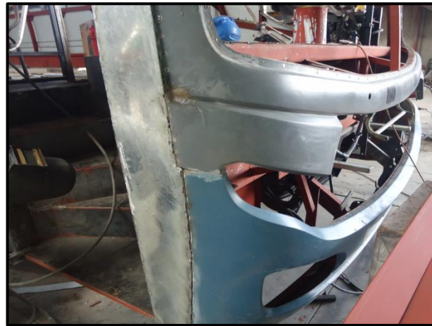
Figura N° 49: Verificación que el parachoque frontal sea de fibra de vidrio. Elaborado por: Investigador
