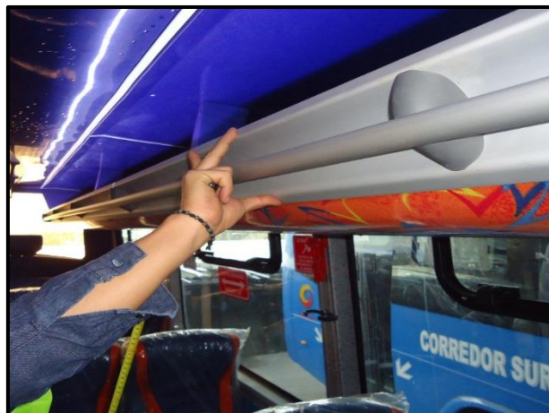
Figura N° 134: Verificación de la inclinación del porta paquetes Elaborado por: Investigador
