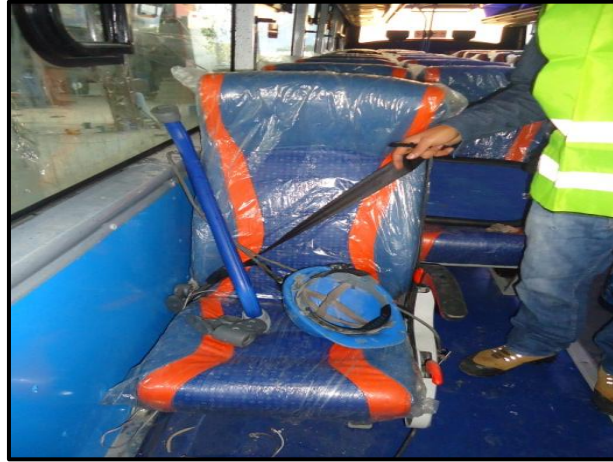
Figura N° 114: Verificación de cinturones de seguridad tres puntos. Elaborado por: Investigador
