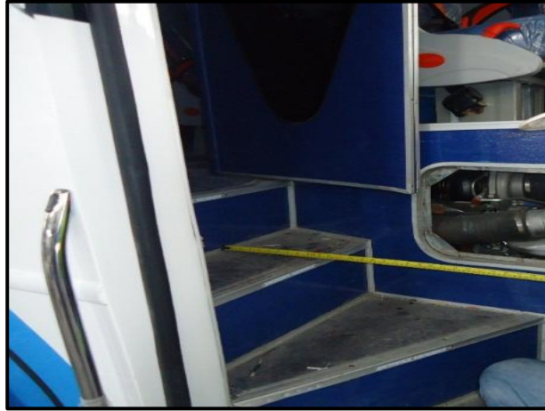
Figura N° 60: Medición del plano horizontal del peldaño Elaborado por: Investigador
