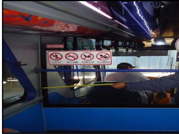
Figura N° 108: Verificación del ancho de la mampara Elaborado por: Investigador
