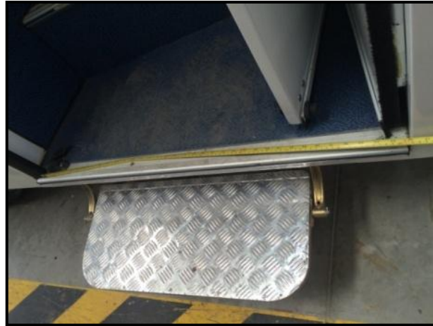
Figura N° 78: Verificación del ancho de puertas y vidrios NTE INEN 1669. Elaborado por: Investigador
