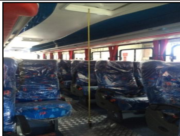
Figura N° 89: Verificación de la altura del corredor central. Elaborado por: Investigador
