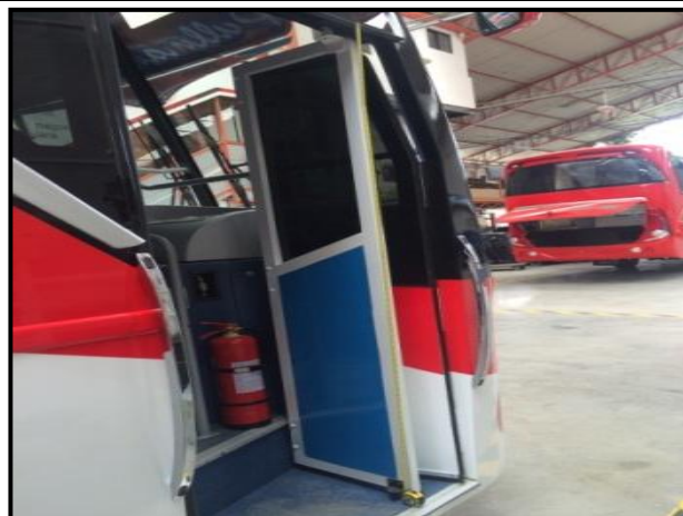
Figura N° 77: Verificación del alto de la puerta de ingreso y salida Elaborado por: Investigador
