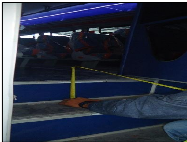
Figura N° 59: Medición del plano vertical del peldaño. Elaborado por: Investigador
