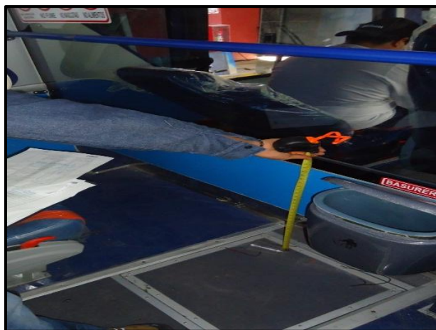
Figura N° 107: Verificación de la altura de las mamparas desde el piso Elaborado por: Investigador
