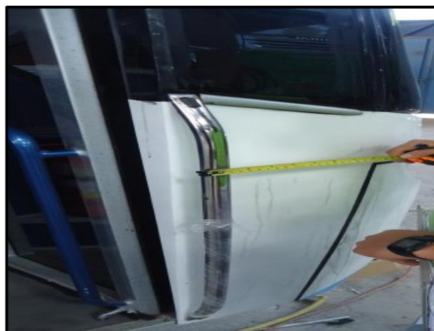
Figura N° 131: Verificación del diámetro de los asideros Elaborado por: Investigador
