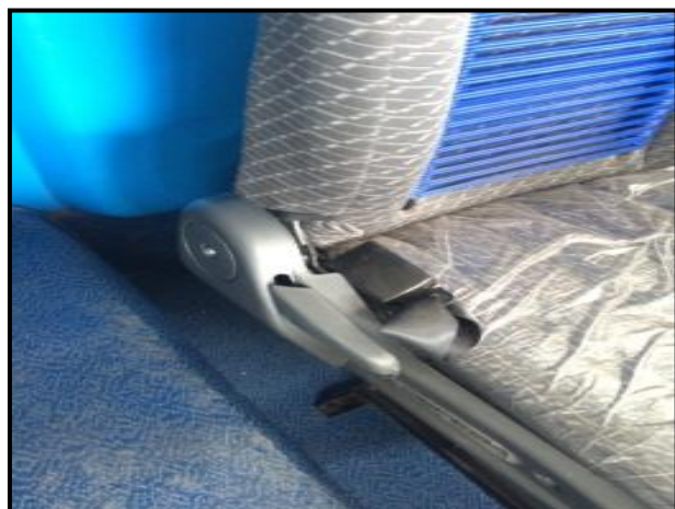
Figura N° 104: Verificación que el asiento del conductor sea reclinable Elaborado por: Investigador
