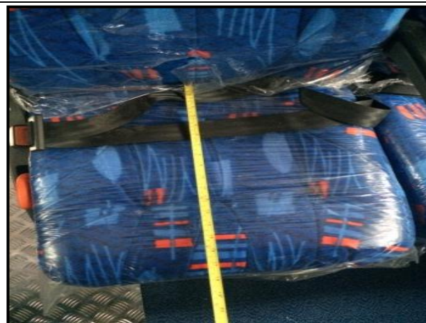
Figura N° 116: Verificación de la profundidad de los asientos Elaborado por: Investigador
