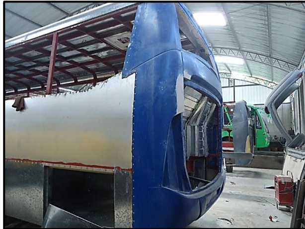
Figura N° 52: Verificación que el parachoque posterior sea de fibra de vidrio Elaborado por: Investigador
