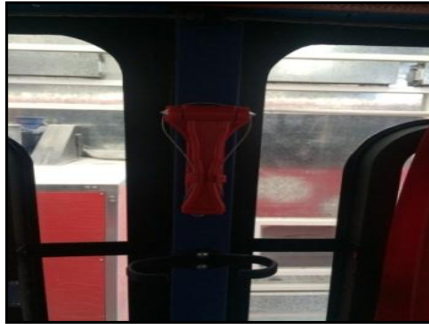
Figura N° 81: Verificación de dispositivo para desprender salida de emergencia Elaborado por: Investigador
