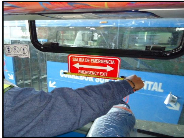
Figura N° 139: Verificación de los rótulos de salidas de emergencia Elaborado por: Investigador
