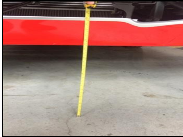
Figura N° 48: Medición de altura máxima inferior del parachoque frontal. Elaborado por: Investigador
