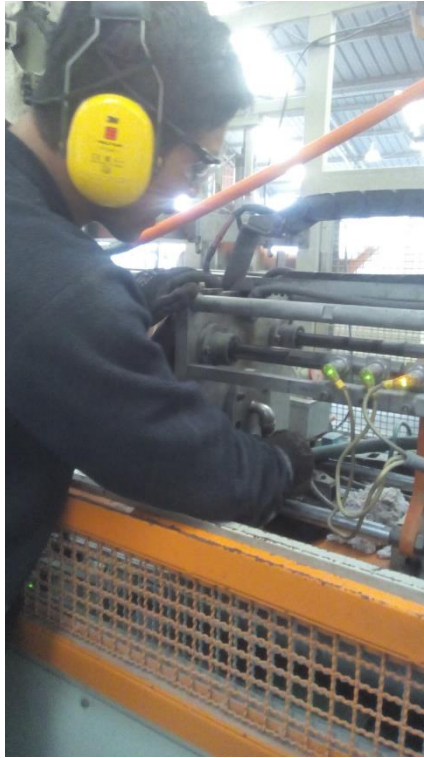
Figura 60: Calibración y colocación de pines para acampanadora
