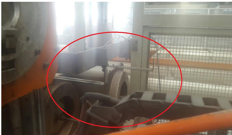
Figura 66: Sensores finales de carrera para decisión de los tiempos de actuación en hornos
