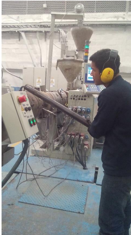
Figura 51: Tablero de encendido de las tinas de vacío y enfriamiento
