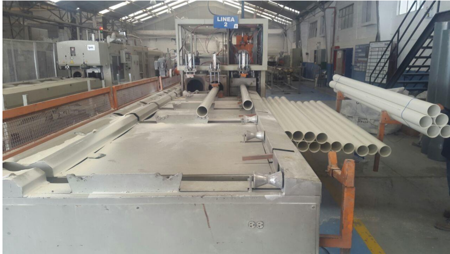
Figura 68: Zona de acampanadora y despacho de tubos
