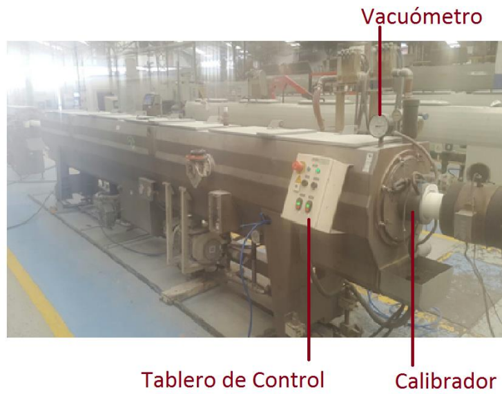
Figura 41: Tina de enfriamiento y Vacío y su conexión con el cabezal de extrusión
