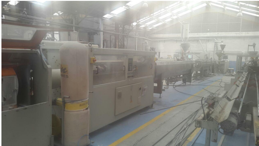
Figura 28: Línea de Extrusión de tubería PVC
