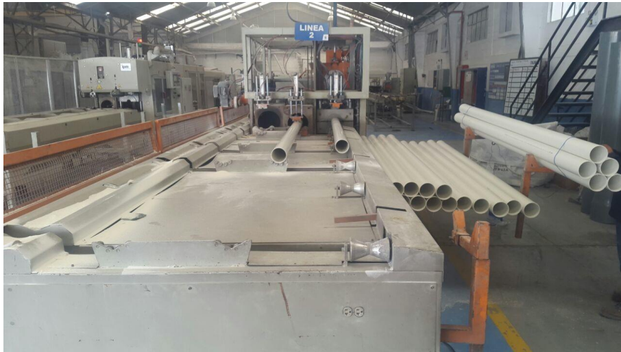
Figura 65: Acampanadora con dos tubos de trabajo aprovechando los tiempos de producción
