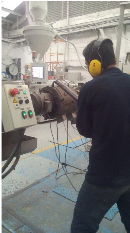
Figura 50: Centrado del Tubo
