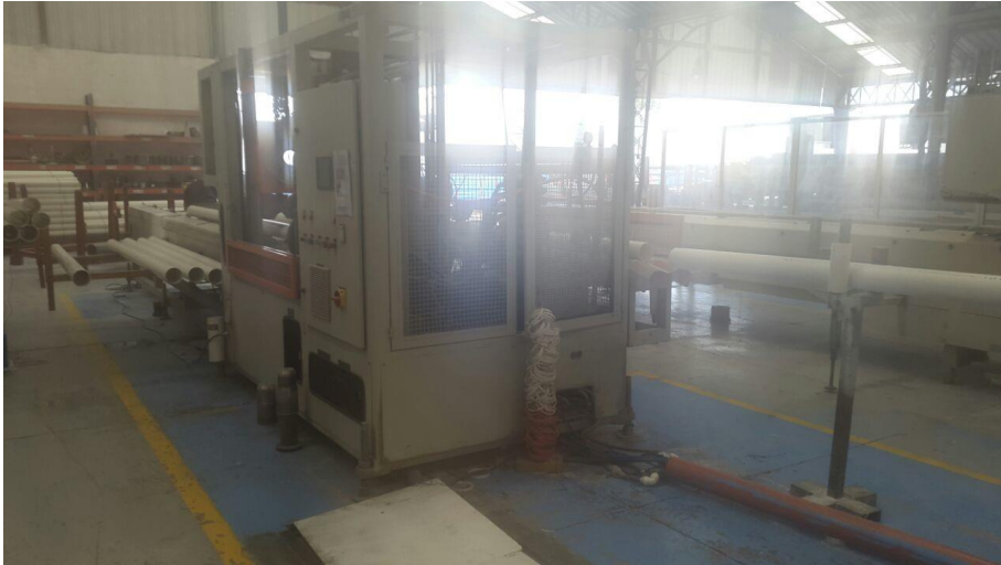
Figura 70: Protección de los hornos de acampanadora a alta temperatura
