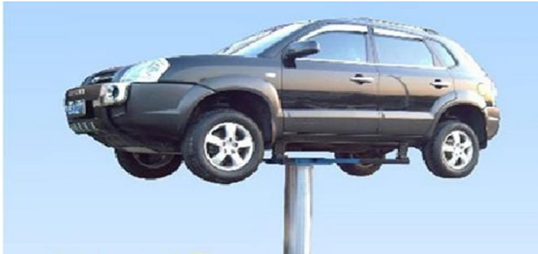
Figura N° 49: Elevador de columna central
