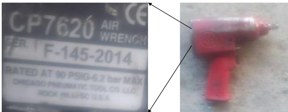
Figura N° 45: Especificaciones técnicas de pistola neumática
