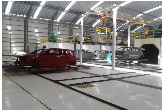
Figura 20. Pintura de Carrocerías Fuente: Ciauto
