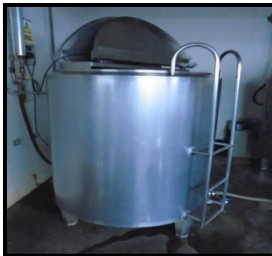
Figura N°. 19: Marmita Fadenox para pasteurizar la leche. Fuente: CORPICECREAM S. A.
