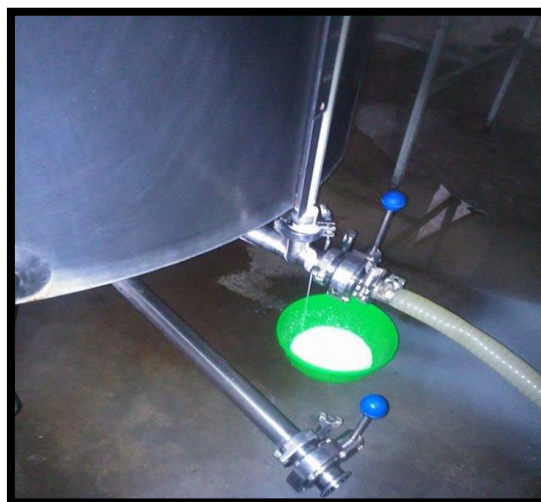
Figura N°. 11: Fuga de leche durante el llenado. Fuente: CORPICECREAM S. A.
