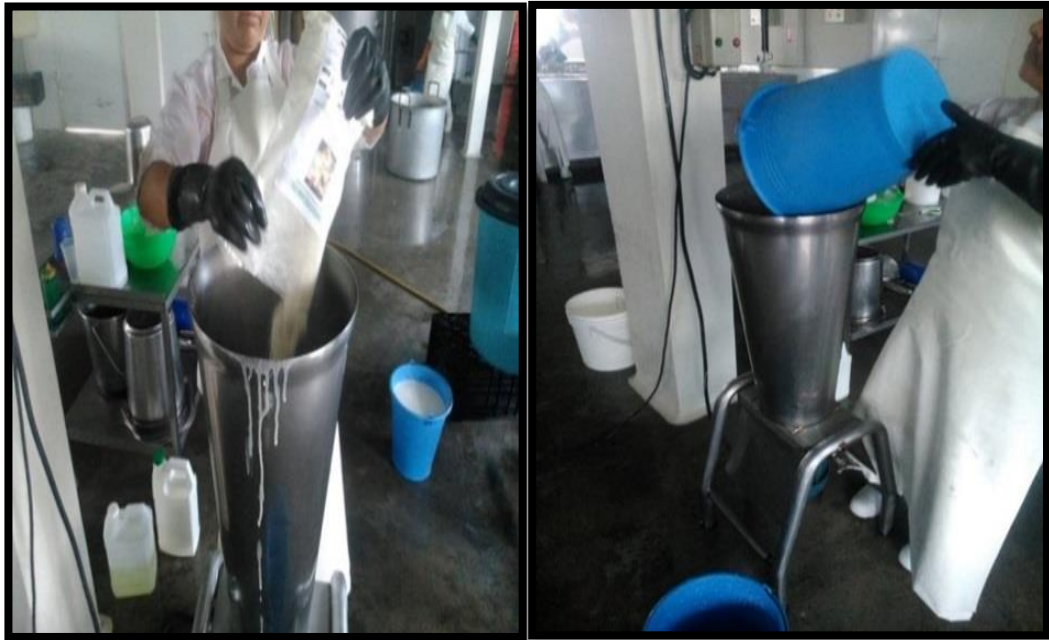
Figura N°. 17: Licuado y dosificación de la leche. Fuente: CORPICECREAM S. A.
