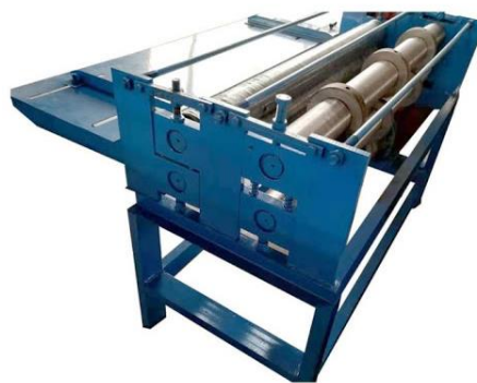
Imagen 1: Máquina de corte de tiras de acero. Fuente: (Haixing Industrial Group Co., 2019).
