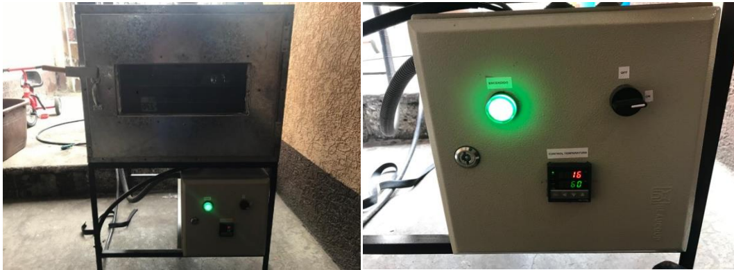
Figura 48 Encendido y programación del equipo.
