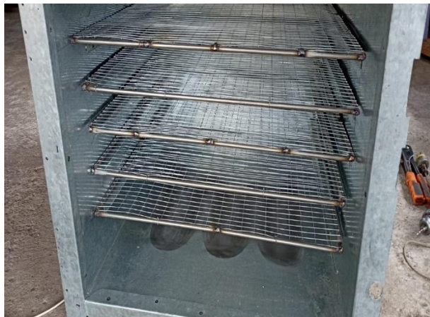
Figura 36 Colocación de mallas.
