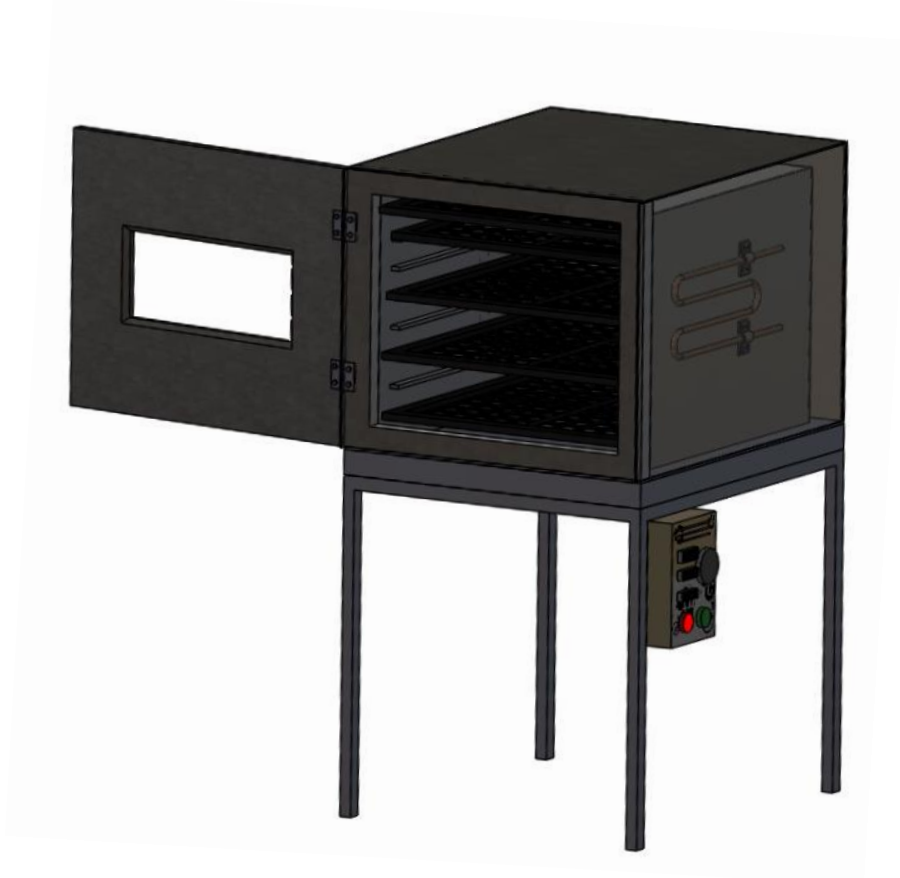
Figura 20 Diseño final de la máquina deshidratadora.
