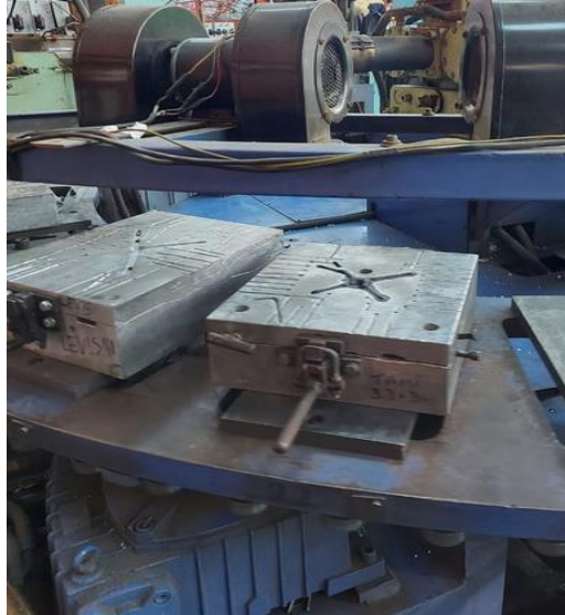
Imagen 6. Ubicación de moldes en cada estación
