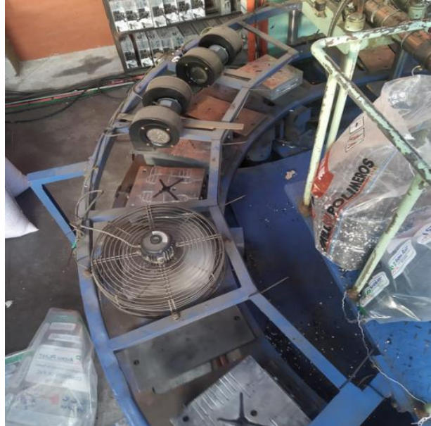
Imagen 8. Etapa de enfriamiento de los moldes. Fuente: Beltrán Inyecciones
