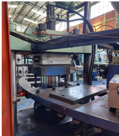
Imagen 7. Proceso de inyección de suelas.
