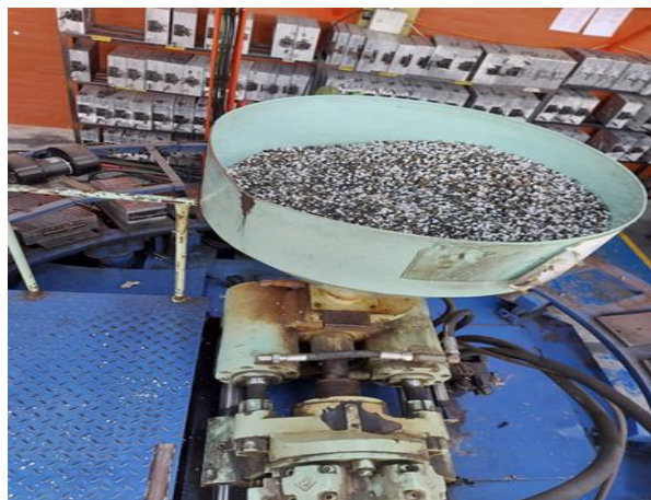
Imagen 3. Abastecimiento del material en la tolva. Fuente: Beltrán Inyecciones
