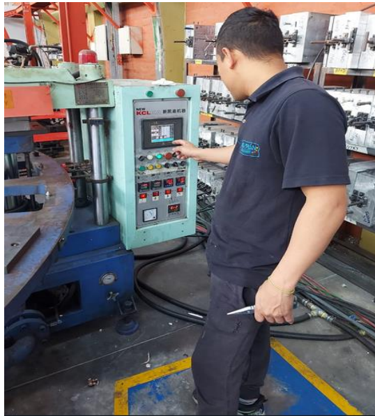
Imagen 4. Ingreso de parámetros de los moldes Fuente: Beltrán Inyecciones
