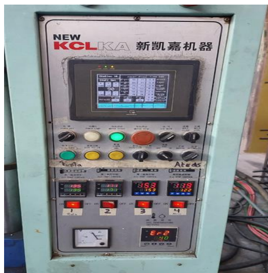
Imagen 5. Interfaz de la máquina de inyección Fuente: Beltrán Inyecciones
