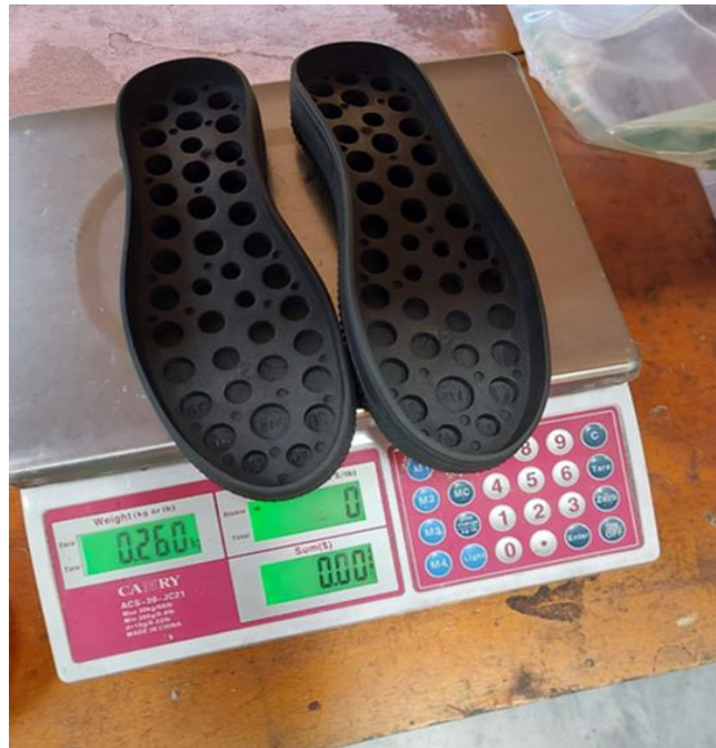
Imagen 12. Inspección del peso de suela. Fuente: Beltrán Inyecciones
